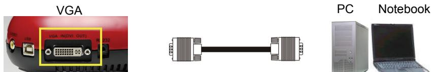
**【Aviso】** Debe utilizar el cable adaptador DVI a VGA.
