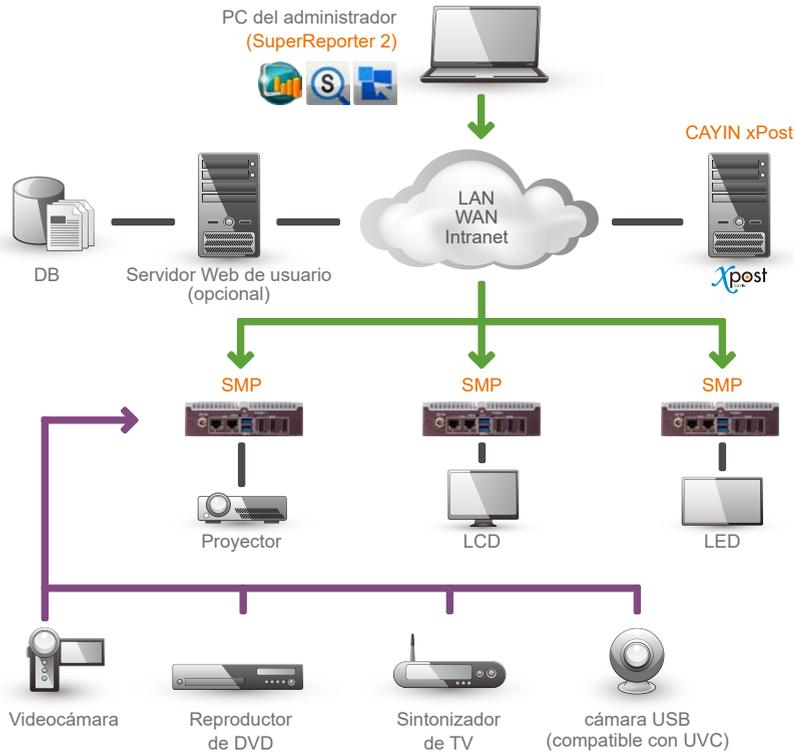
Red de señalización digital con estructura cliente-servidor (servidor CMS + reproductor SMP)
